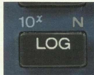
Doc. 4 Les touches LOG et 10 x permettent respectivement le calcul du pH et de la concentration en ions oxonium.
